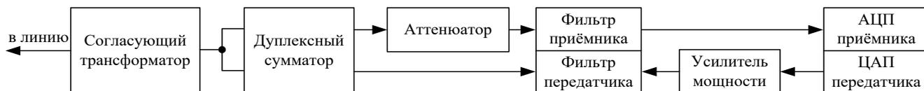
Рисунок 1.9 – Структурная схема ВЧ тракта аппаратуры СТРЕЛА в дуплексном режиме работы
