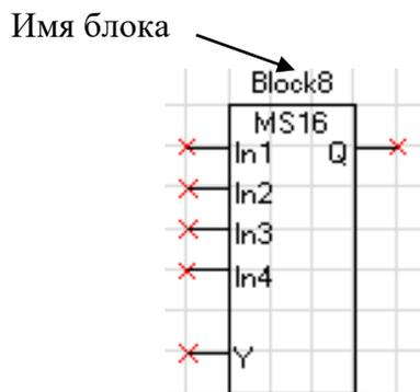
Рисунок 6.35 – Мультиплексор 16-разрядный
