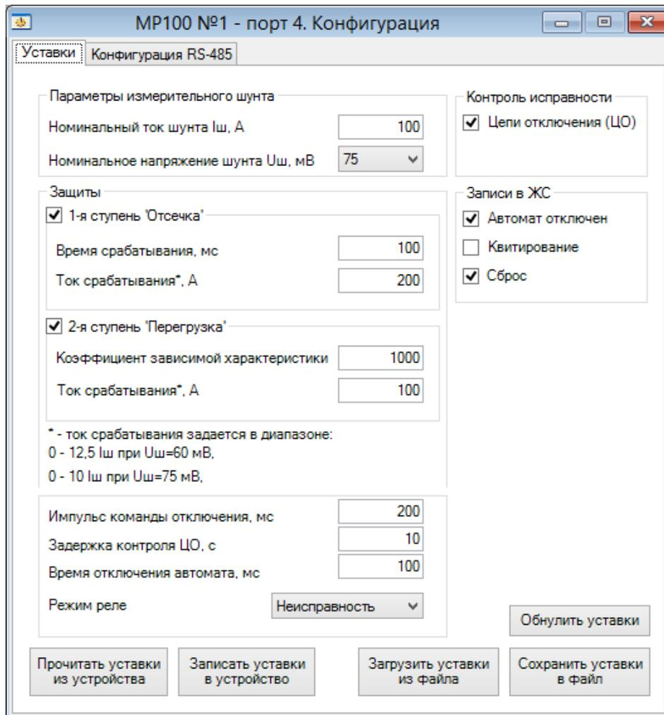
Рисунок 3.6 – Окно «Уставки» MP100 программного обеспечения УниКон версия ПО 5.40 и выше
