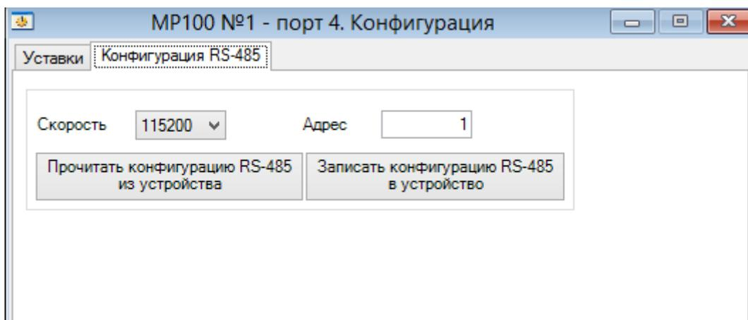
Рисунок 3.7 – Окно «Конфигурация RS-485» программного обеспечения УниКон
