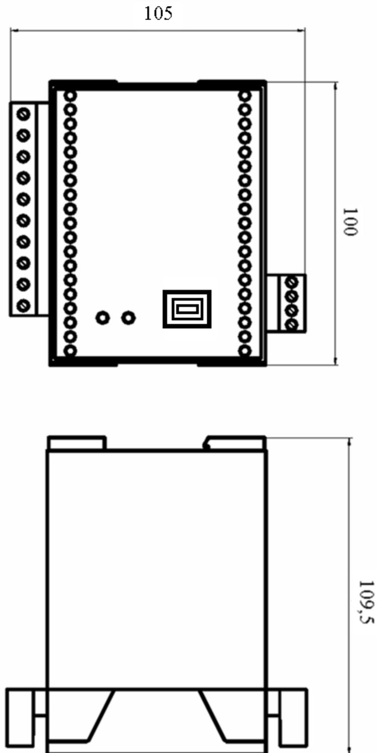
Рисунок А.1 – Габаритные размеры МР100
