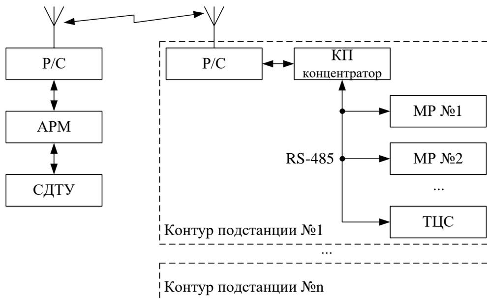
МР – микропроцессорное реле защиты энергооборудования; P/C – радиостанция;
