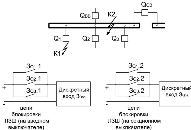
Рисунок 11.11 – Принцип действия логической защиты шин
