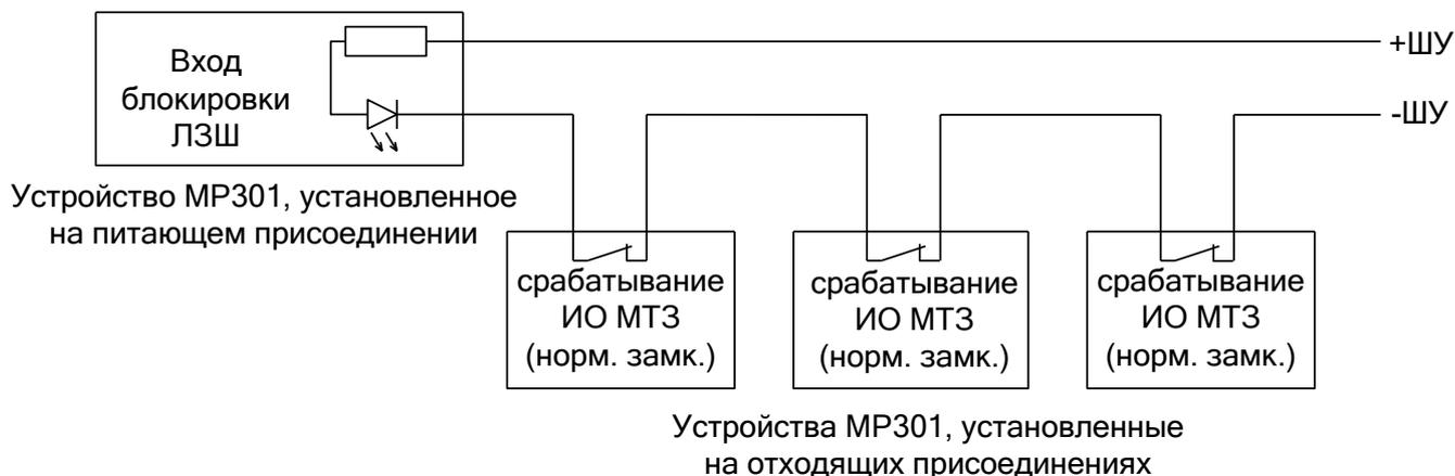
Рисунок 6.12 – Принцип организации логической защиты шин (последовательная схема)
