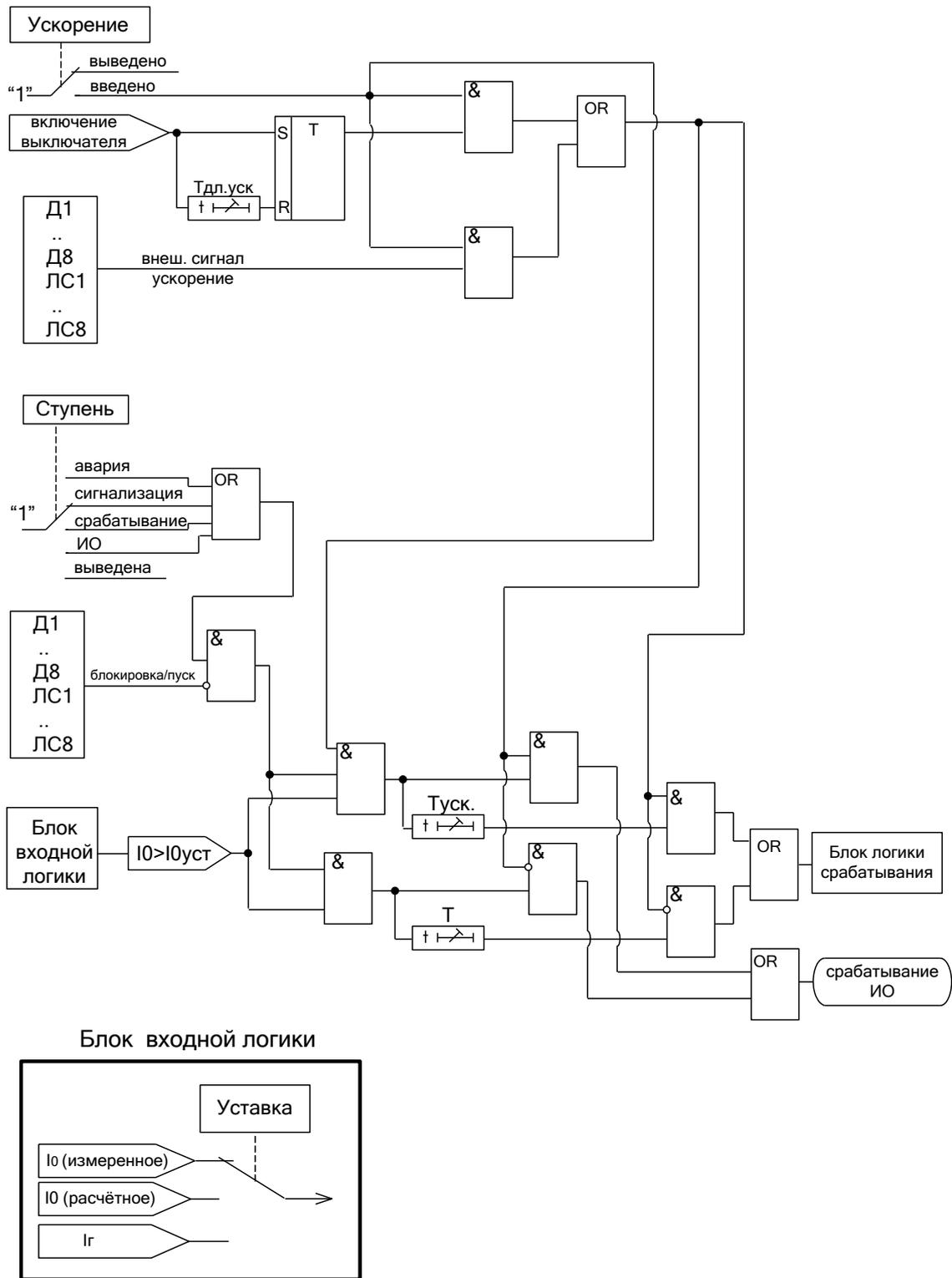
Рисунок 6.4 – Блок защиты от замыканий на землю
