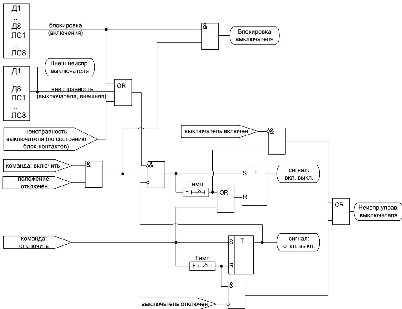
Рисунок 5.4 – Логика выдачи сигналов на включение/отключение выключателя
