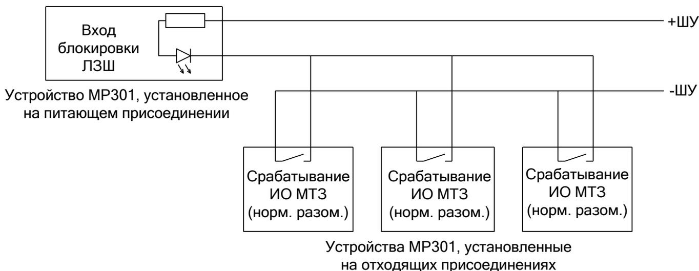
Рисунок 6.11 – Принцип организации логической защиты шин (параллельная схема)
