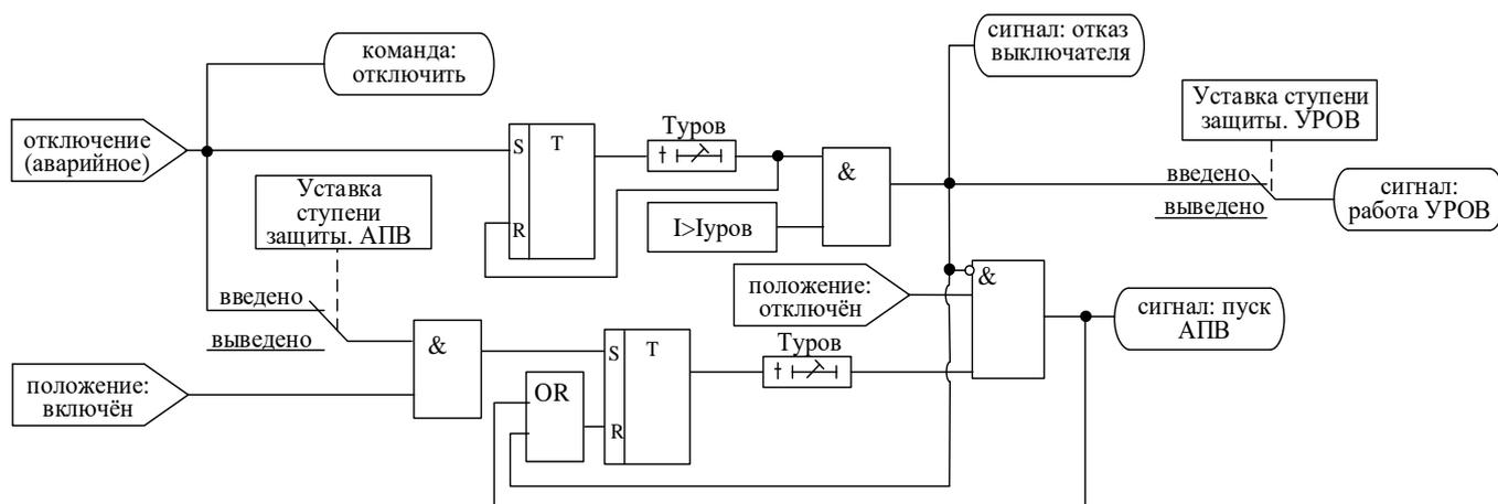
Рисунок 5.5 – Логика работы при аварийном отключении
