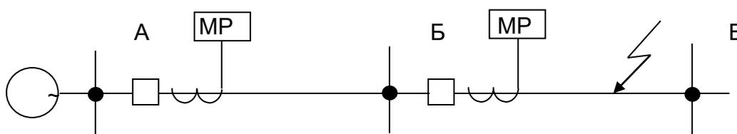
Рисунок 6.2 – К выбору зависимой характеристики смежных участков.
