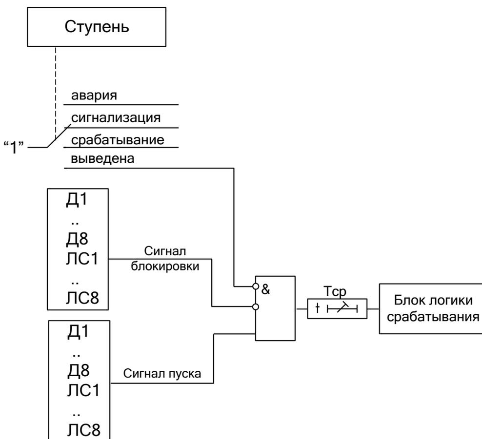
Рисунок 6.6 – Логика работы с внешней защитой
