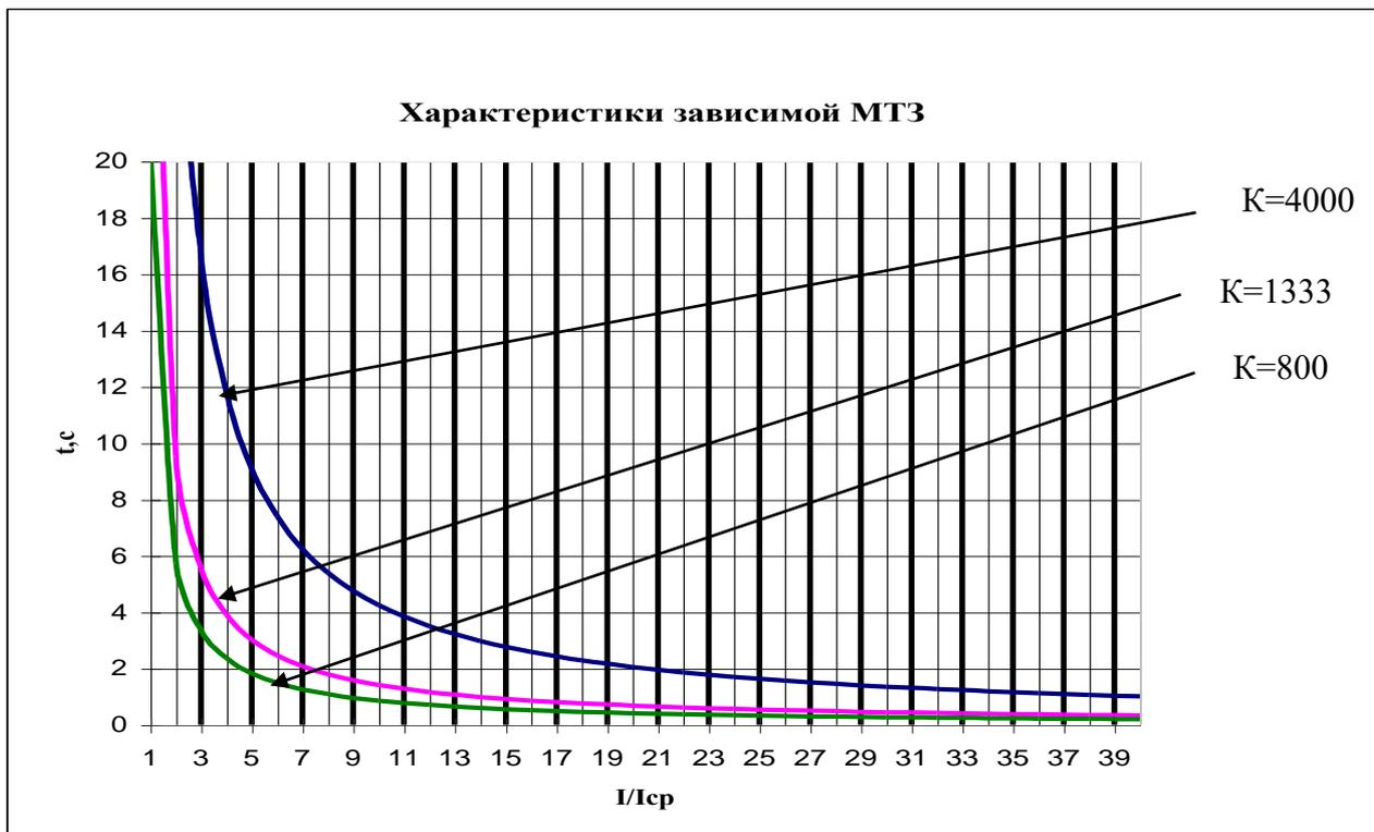
Рисунок 6.1 – Графики зависимой характеристики
