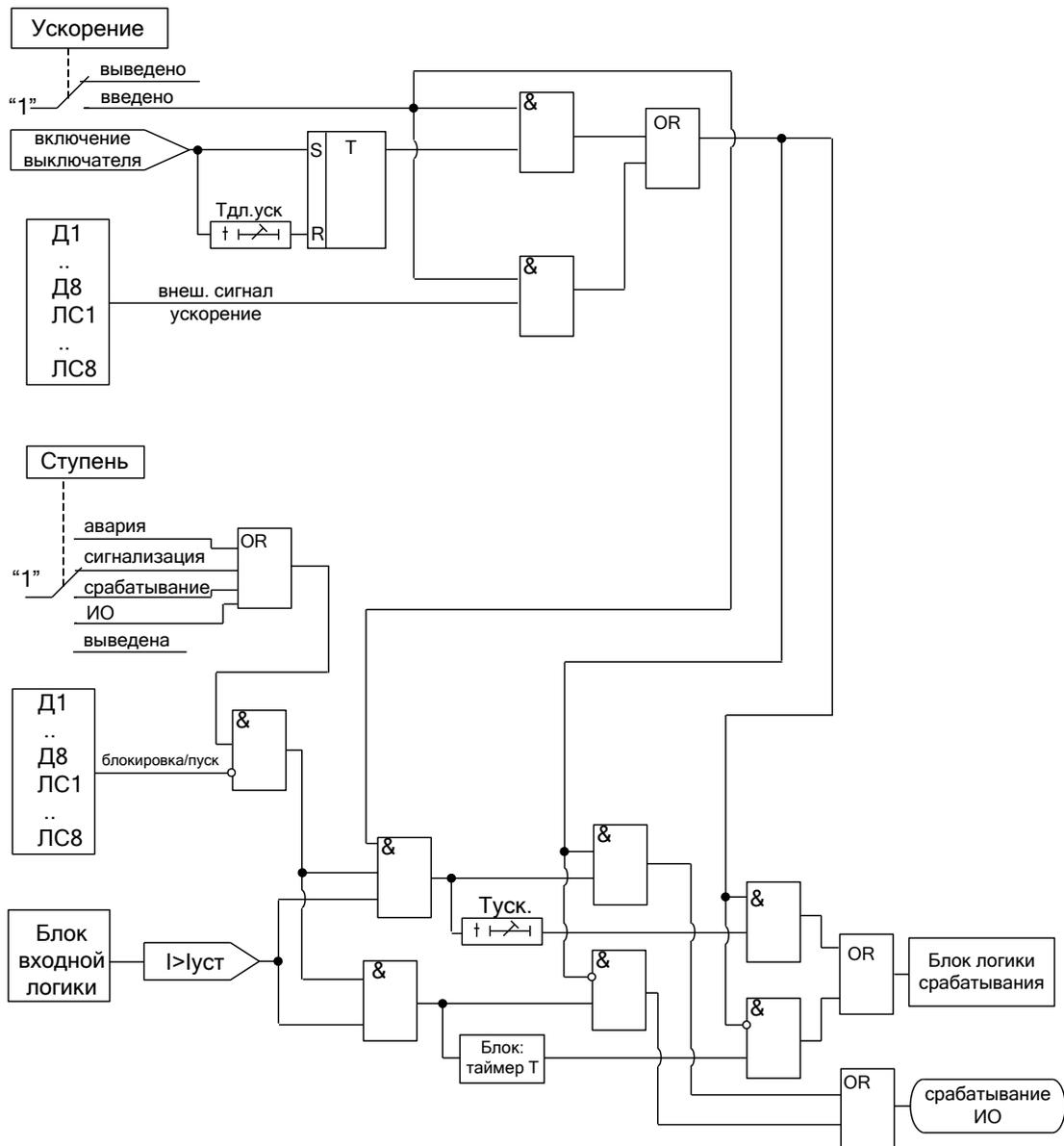
Рисунок 6.3а – Блок МТЗ при междугазных КЗ (основная логика)
