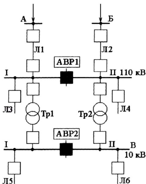
Рисунок 11.9 – Схема нормально разомкнутой распределительной сети
