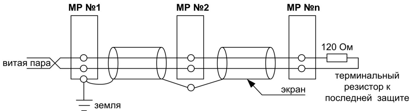
Рисунок 8.2 – Схема подключения кабеля
