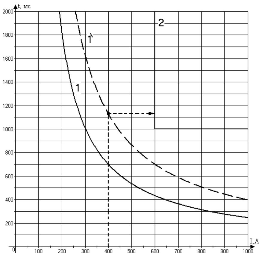
Рисунок 11.8 – Пример согласования обратнозависимой характеристики МР301 и независимой характеристики МТЗ последующего элемента
