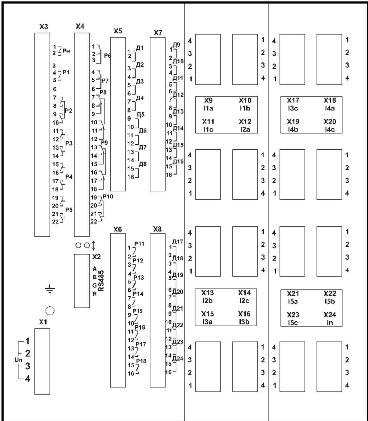
Рисунок А.3 – Вид задней панели MP902
