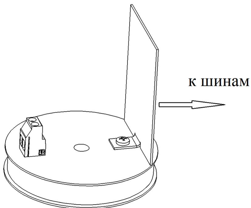
Рисунок А.3 – Установка датчика напряжения
