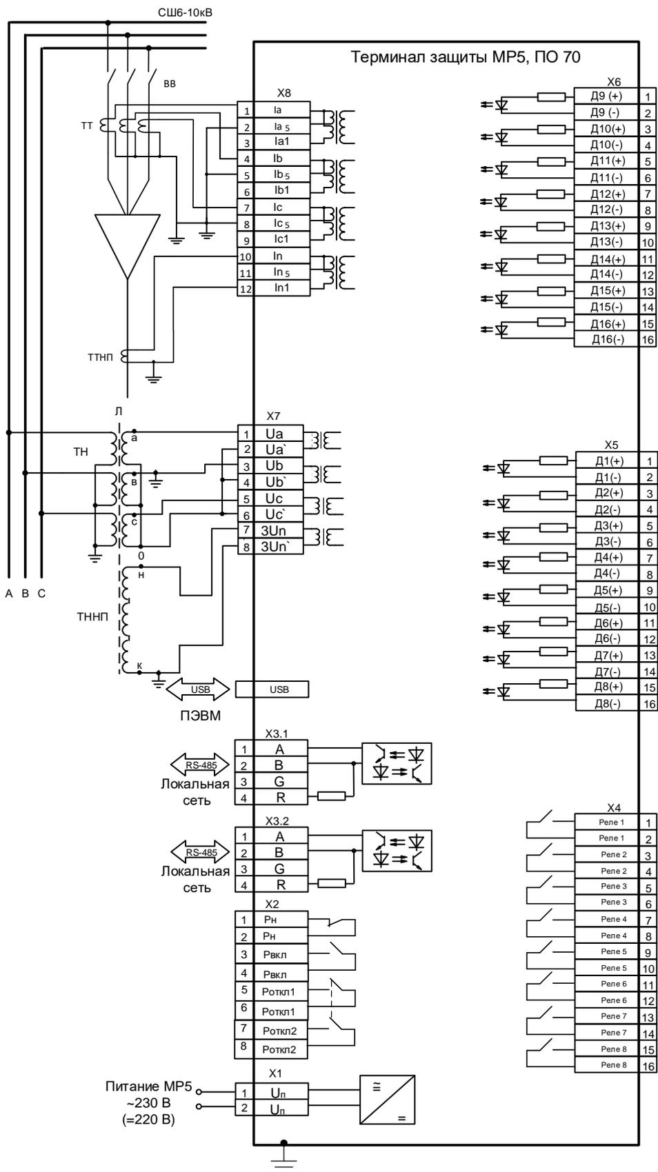
Рисунок В.3 – Схема с 3-мя трансформаторами тока МР5, ПО 70.
