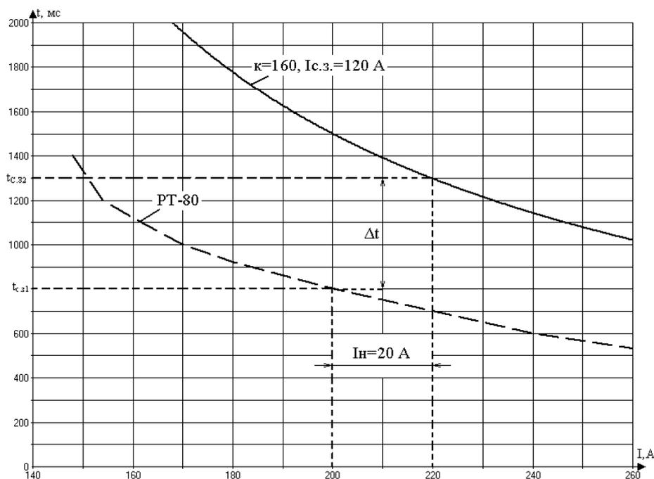
Рисунок 10.8 – Пример согласования характеристик устройства МР5 и дискового индукционного реле РТ-80
