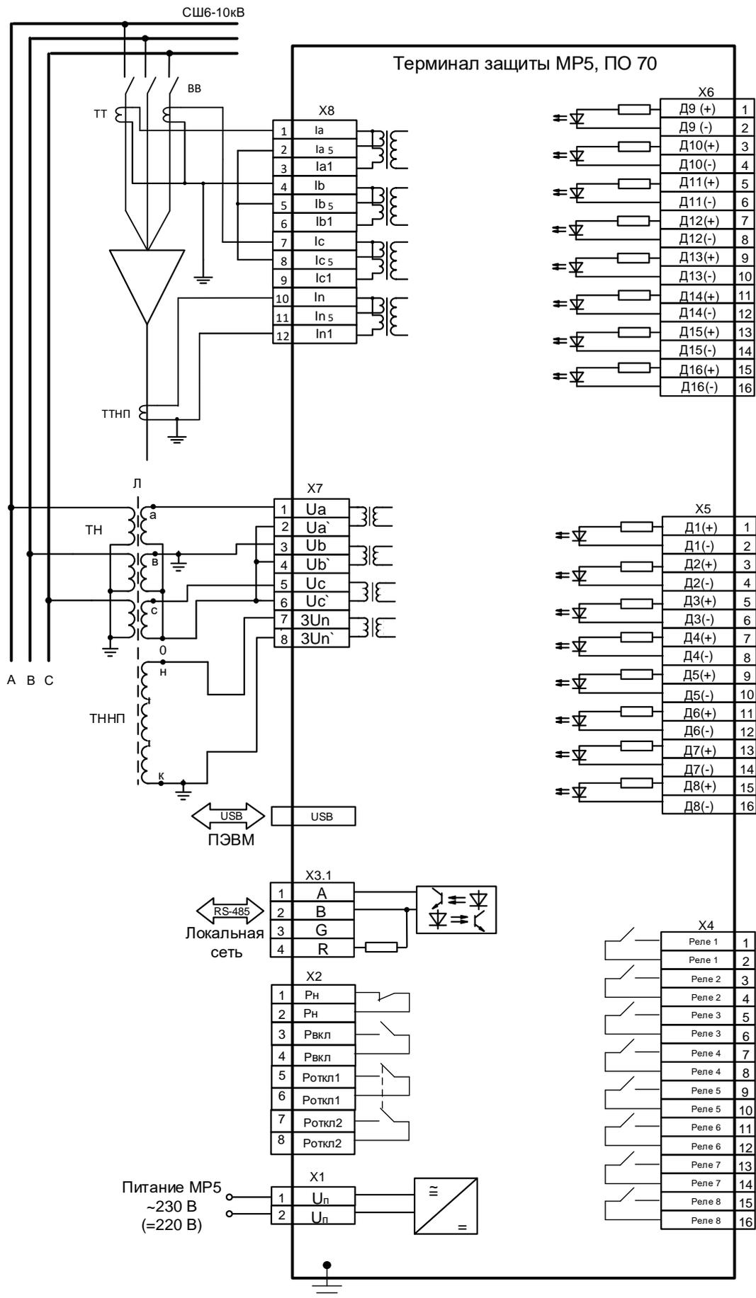
Рисунок В.2 – Схема с 2-мя трансформаторами тока.
