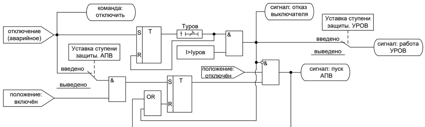
Рисунок 5.5 – Логика работы МР5 при аварийном отключении
