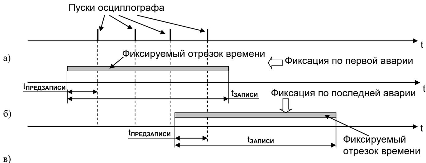
Рисунок 7.2 – Пояснения к значениям параметра «Фиксация»
