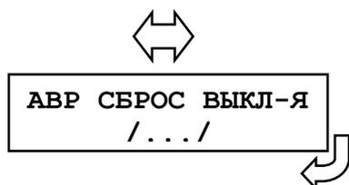
Сброс блокировки АВР, возврат схемы АВР в начальный шаг по включению/отключению выключателя.
