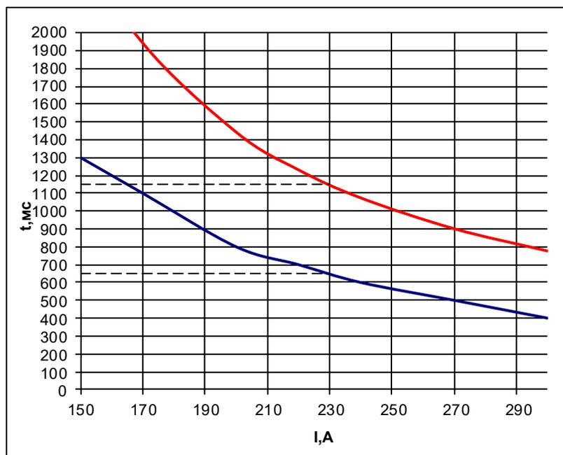
Рисунок 10.7а - Пример согласования характеристик устройства MP5 и дискового индукционного реле РТ-80 для направленной МТЗ
