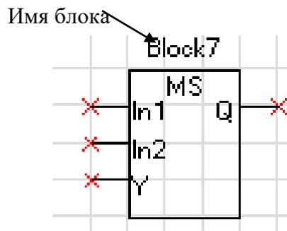
Рисунок 6.46 – Мультиплексор
