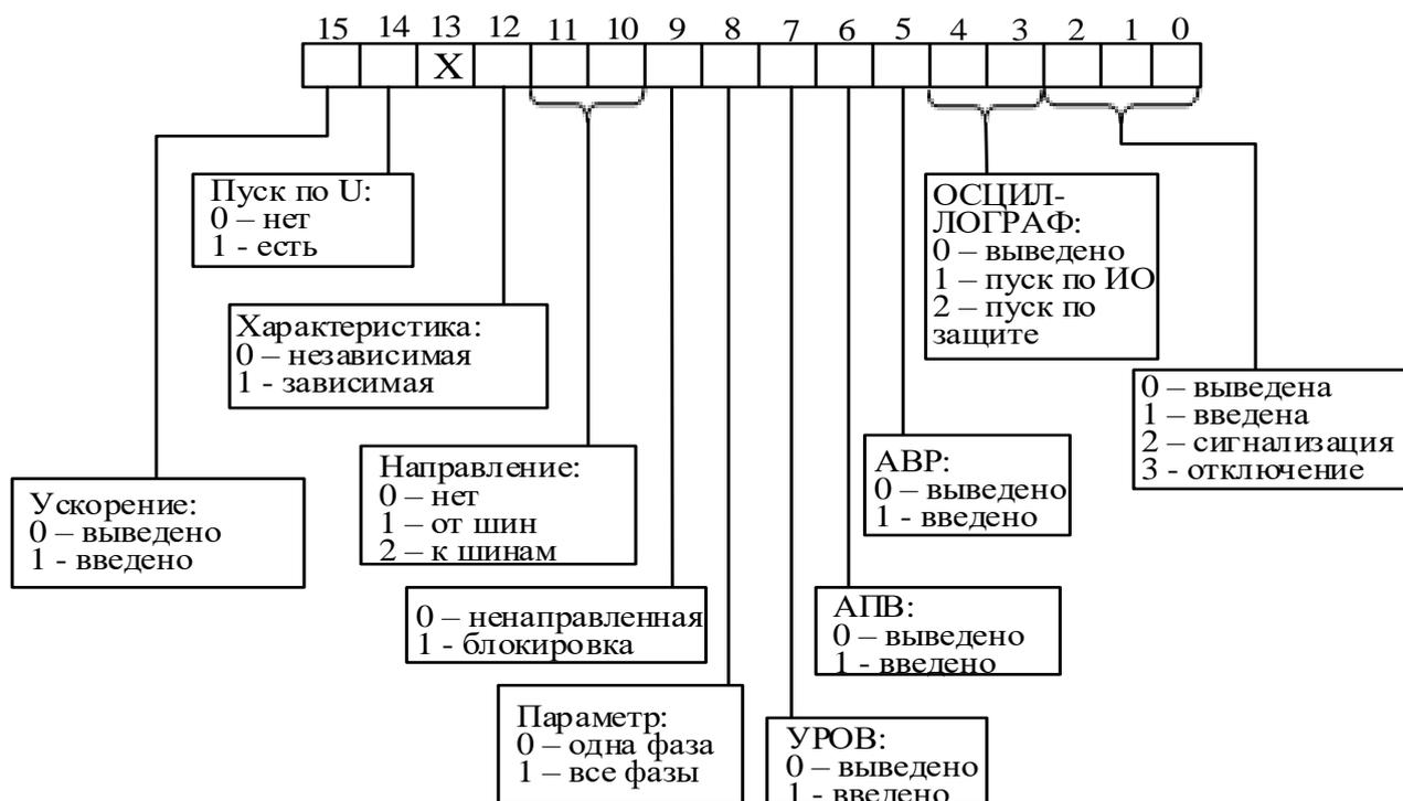
**46\*** – конфигурация направленной защиты от повышения тока нулевой последовательности ( $I_{0>}$ ,  $I_{0>>}$ ,  $I_{n>}$ ,  $I_{n>>}$ ) и направленной защиты от повышения тока обратной последовательности ( $I_{2>}$ ,  $I_{2>>}$ ):
