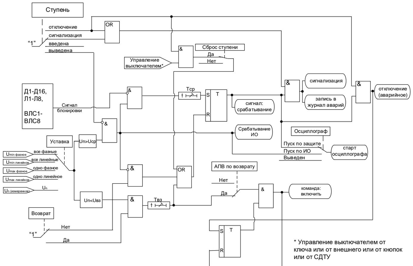
Рисунок 6.12 – Блок защиты от повышения напряжения
