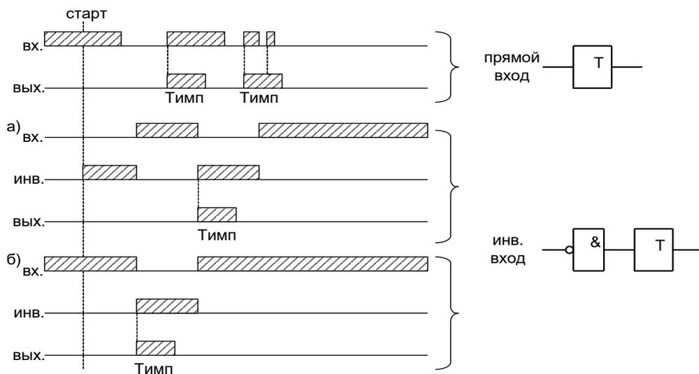
Рисунок 6.42 – Импульсный таймер по фронту типа 1 (таймер 3)
