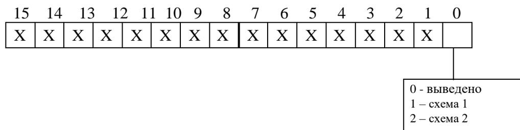
**I2\*** конфигурация реле «НЕИСПРАВНОСТЬ»:
