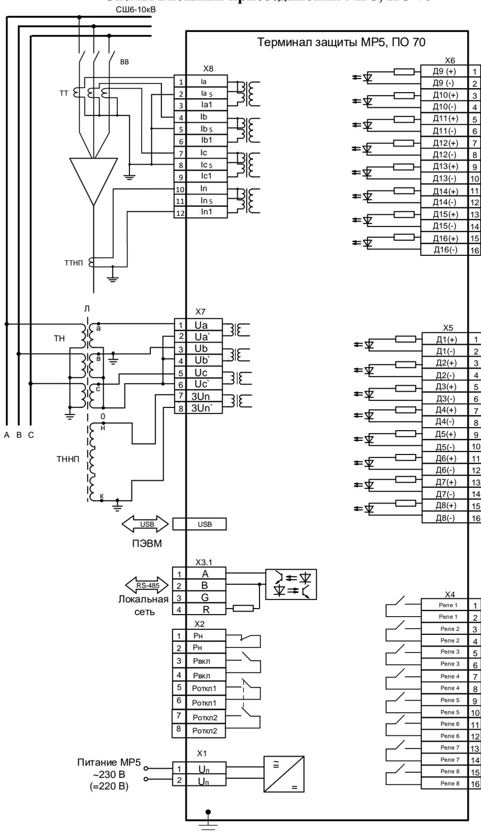
Рисунок В.1 – Схема с 3-мя трансформаторами тока.
