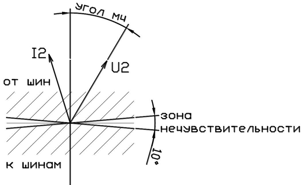
Рисунок 6.8 – Зона срабатывания направленной защиты  $I_2$
