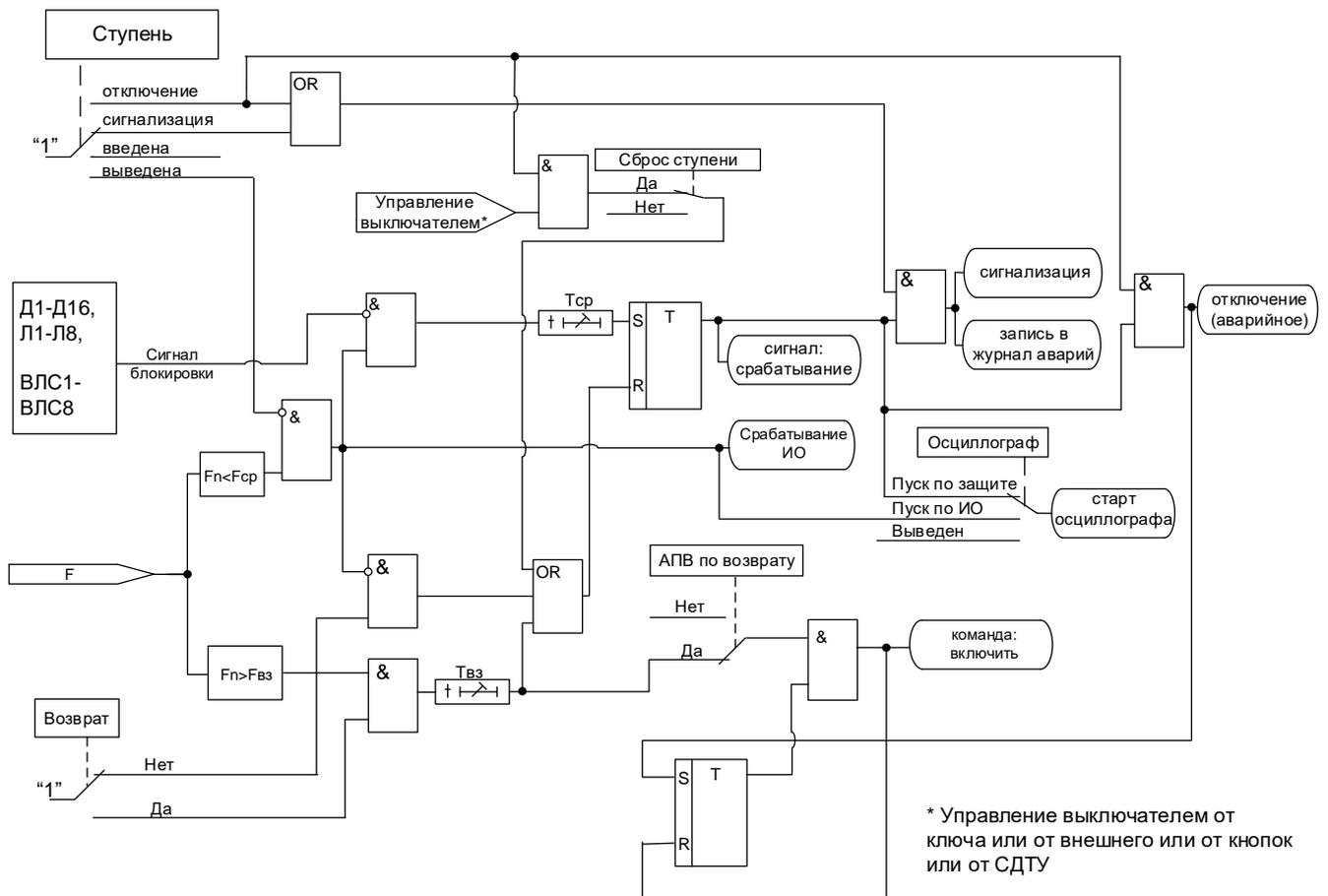
Рисунок 6.17 – Блок защиты от понижения частоты
