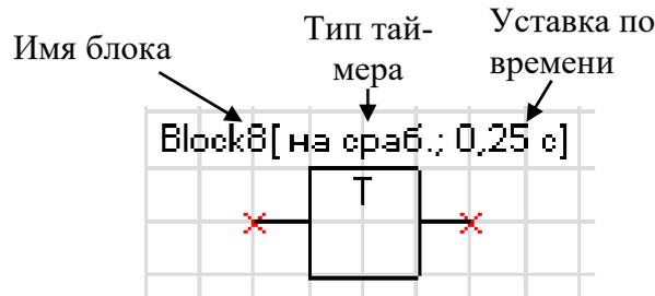
Рисунок 6.39– Таймер
