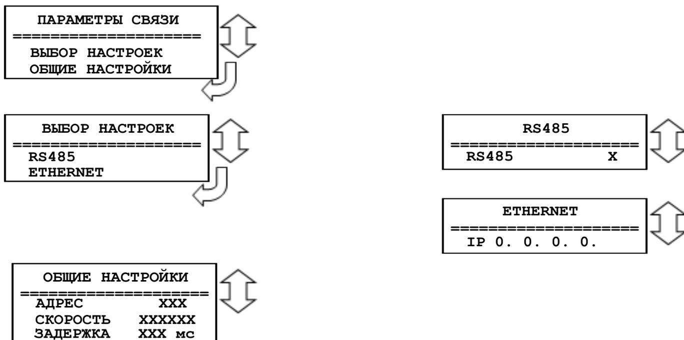
«Адрес» - Назначение номера устройства в сети.
