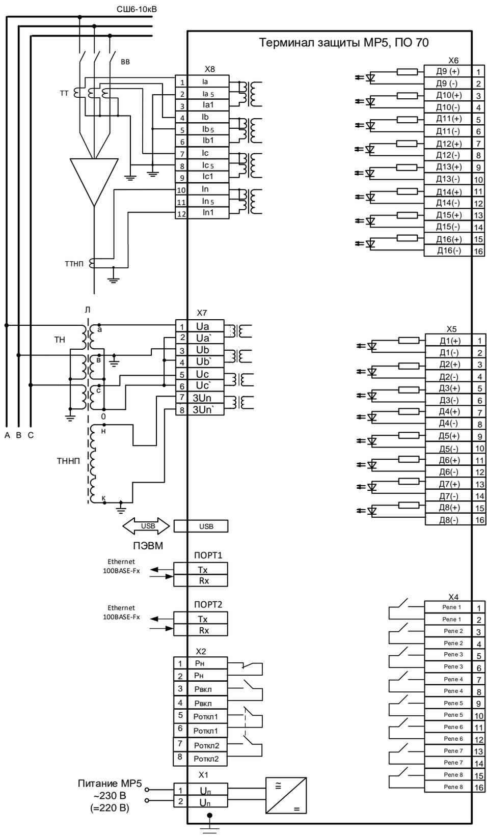
Рисунок В.4 – Схема с 3-мя трансформаторами тока МР5, ПО 70.
