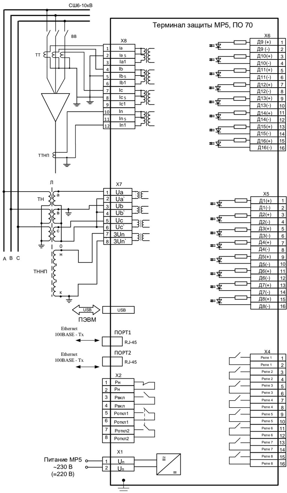
Рисунок В.5 – Схема с 3-мя трансформаторами тока MP5, ПО 70.
