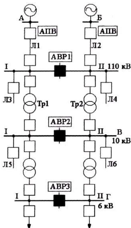
Рисунок 10.14 – Схема нормально разомкнутой распределительной сети с несколькими линиями АВР и АПВ
