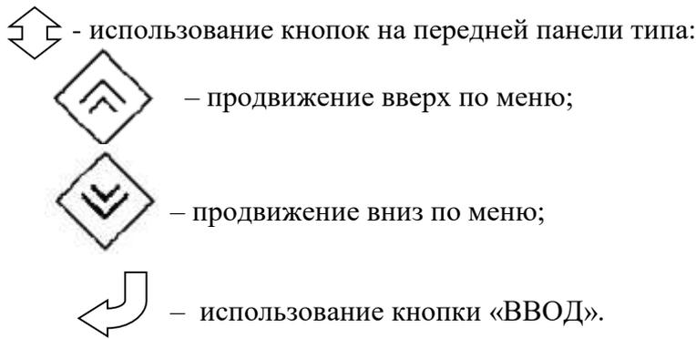
Для удобства просмотра параметров, пользователь может просмотреть содержание пунктов меню, удерживая выбранную им клавишу. При этом на экране светодиодного дисплея циклически высветятся имеющиеся параметры в выбранном пункте.
