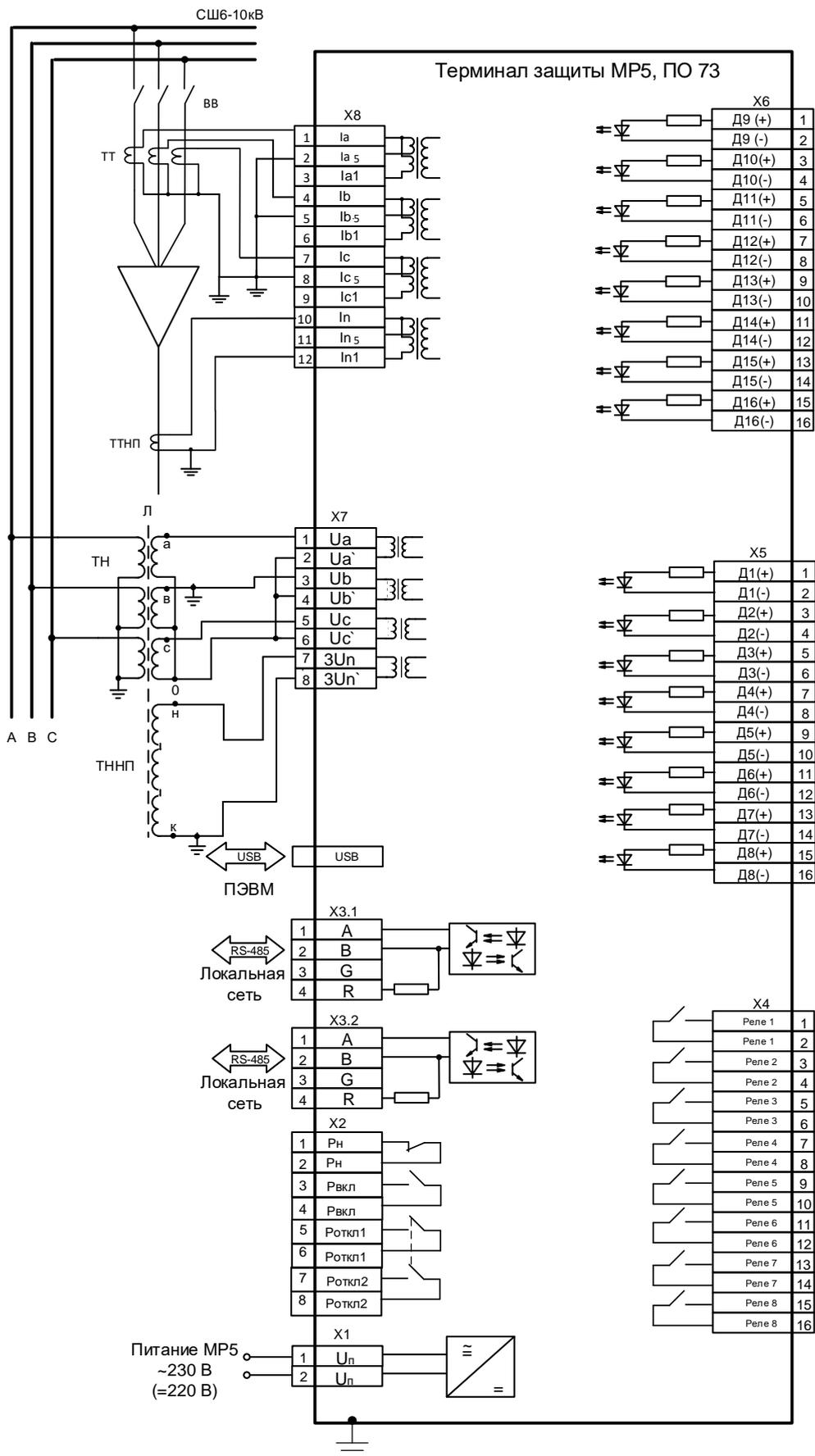
Рисунок В.3 – Схема с 3-мя трансформаторами тока МР5, ПО 73.
