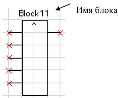
Рисунок 6.40 – Логический элемент «Исключающее ИЛИ»
