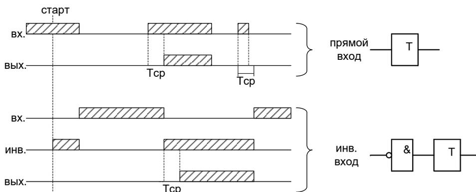
Рисунок 6.44 – Таймер на срабатывание (таймер 1)
