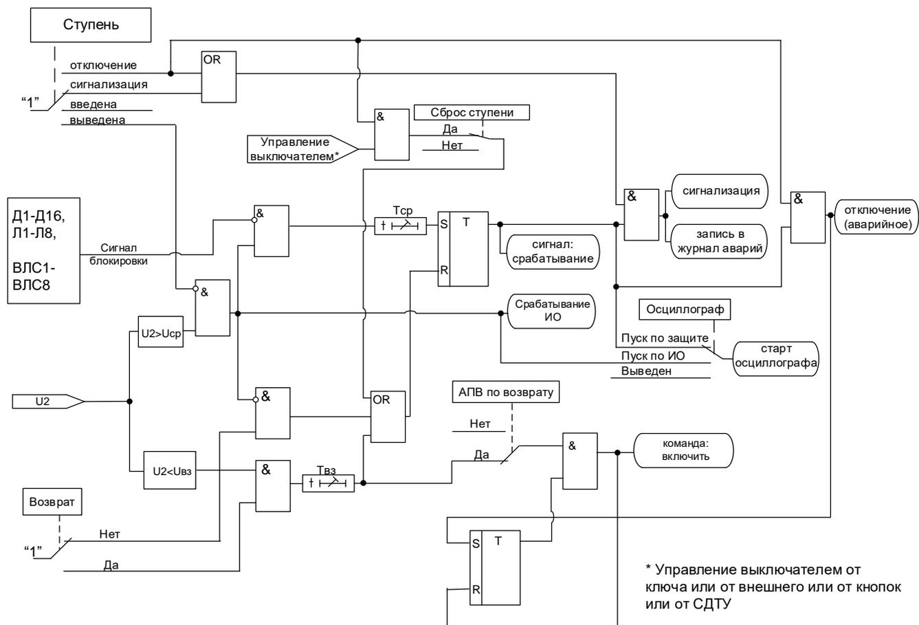
Рисунок 6.15 – Блок защиты от повышения напряжения обратной последовательности
