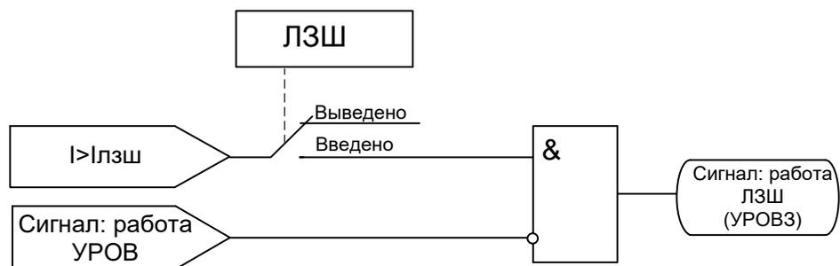
Рисунок 10.17 – Логическая схема УРОВЗ
