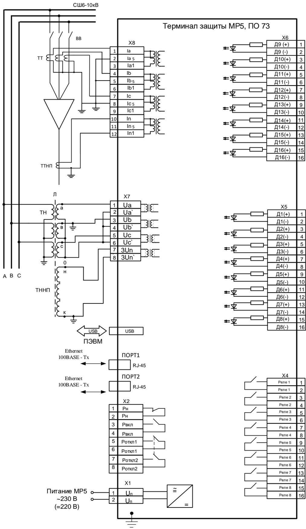
**Рисунок В.5 – Схема с 3-мя трансформаторами тока МР5, ПО 73.
