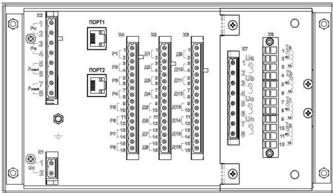
Рисунок Б.4 – Вид задней панели терминала защиты энергооборудования MP5. **Вариант 4**
