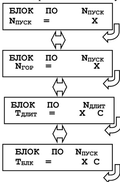
Ввод числа горячих пусков, при котором последующие пуски будут блокированы. Диапазон значений: 0-10.
