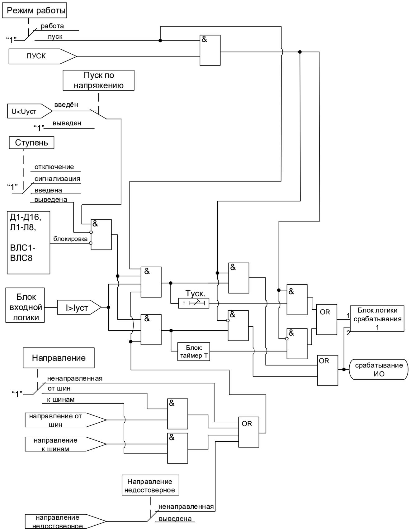
Рисунок 6.46 – Логическая схема ступеней I>>>, I>>>> MP5 ПО73
