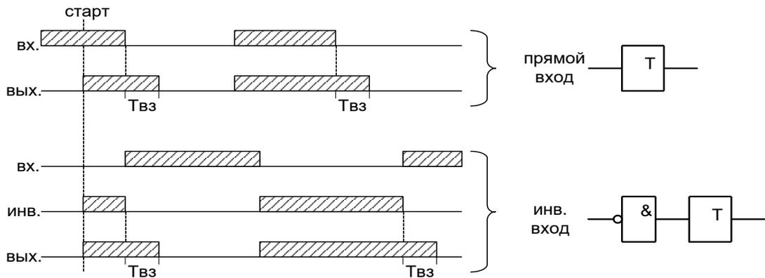
Рисунок 6.45 – Таймер на возврат (таймер 2)
