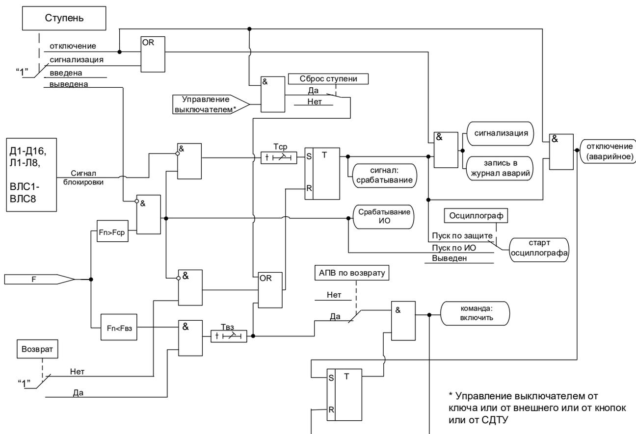
Рисунок 6.16 – Блок защиты от повышения частоты
