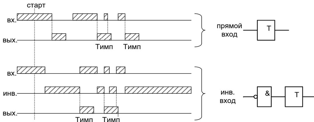
Рисунок 6.47 – Импульсный таймер по спаду типа 1 (таймер 4)
