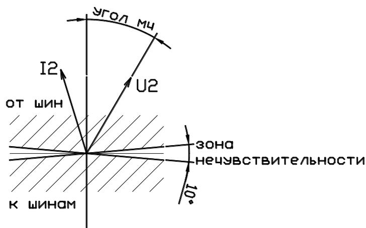
Рисунок 6.8 – Зона срабатывания направленной защиты  $I_2$
