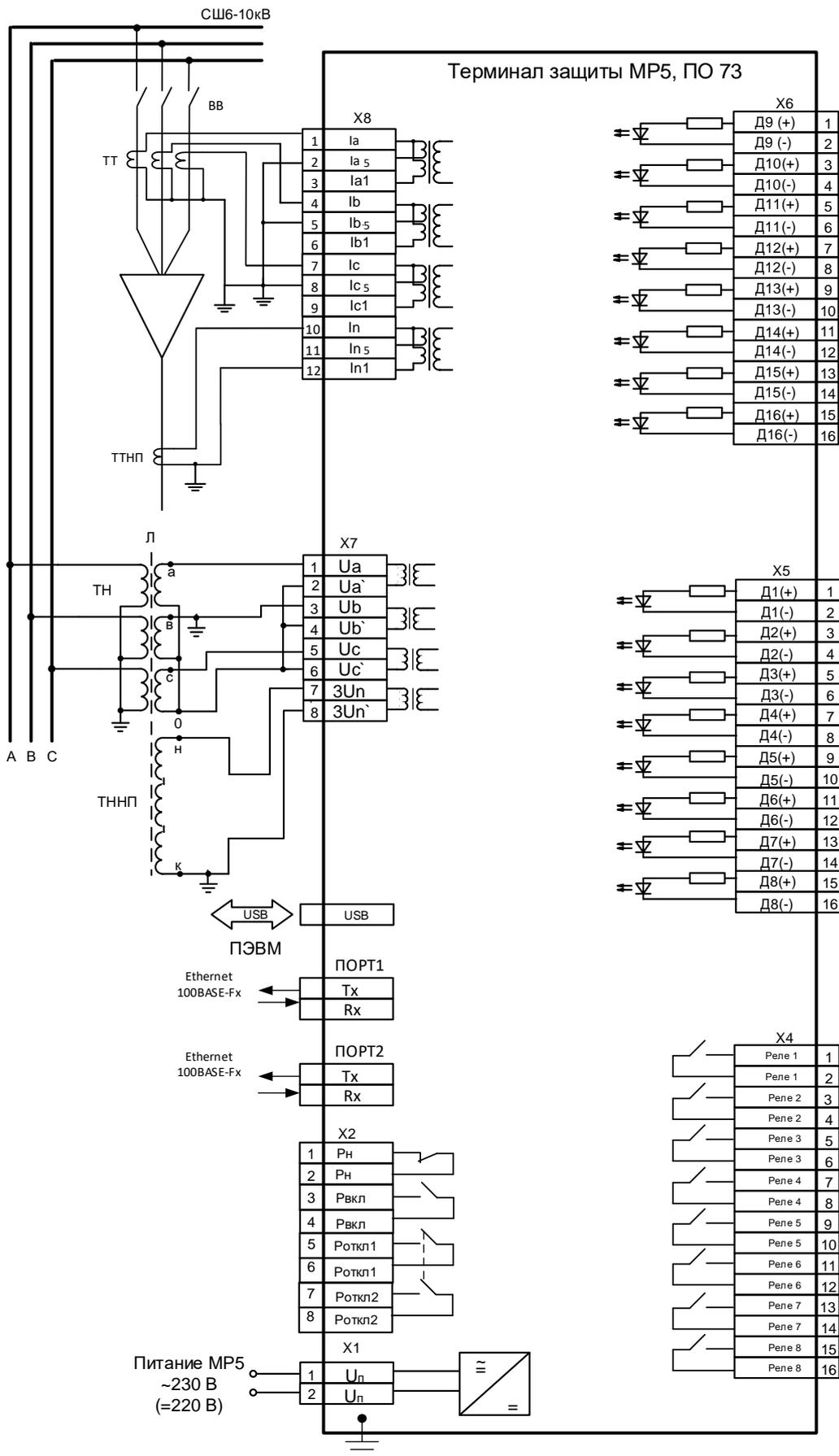
Рисунок В.4 – Схема с 3-мя трансформаторами тока МР5, ПО 73.
