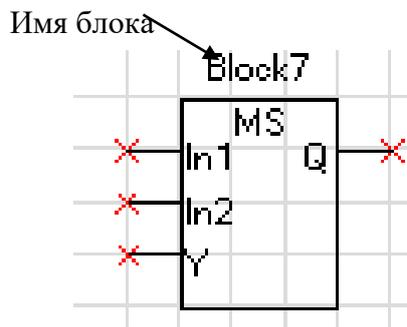
Рисунок 6.50 – Мультиплексор
