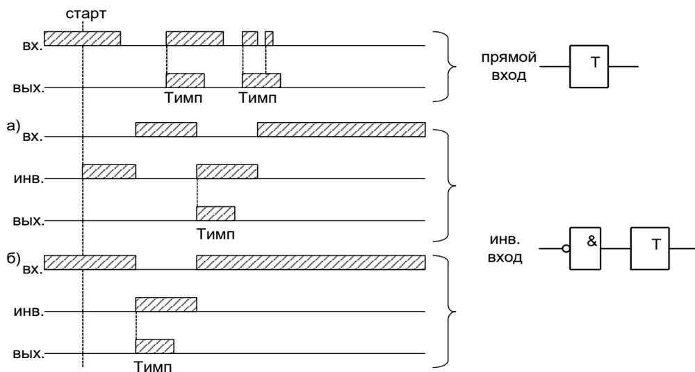
Рисунок 6.46 – Импульсный таймер по фронту типа 1 (таймер 3)
