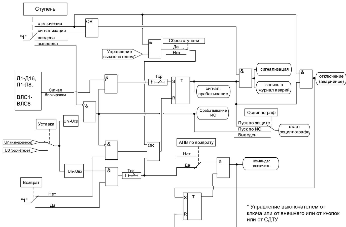
Рисунок 6.14 – Блок защиты от повышения напряжения нулевой последовательности
