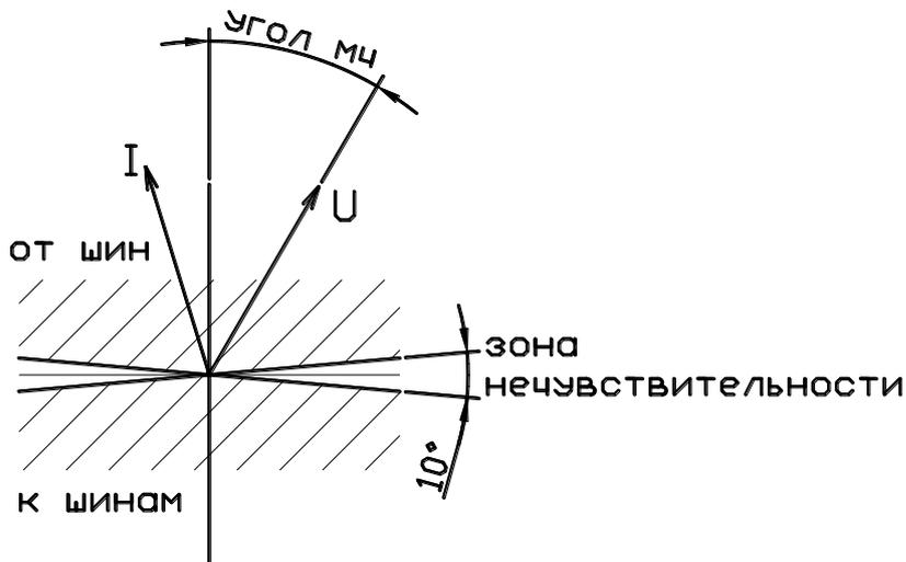
Рисунок 6.1 – Зона срабатывания направленной защиты
