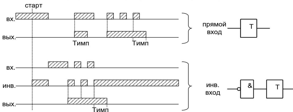
Рисунок 6.48 – Импульсный таймер по фронту типа 2 (таймер 5)
