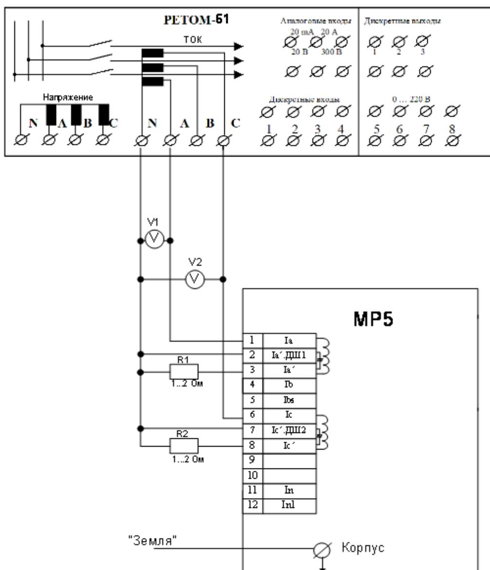
Рисунок 11.1 – Схема подключения MP5 для проверки работоспособности дешунтирования
