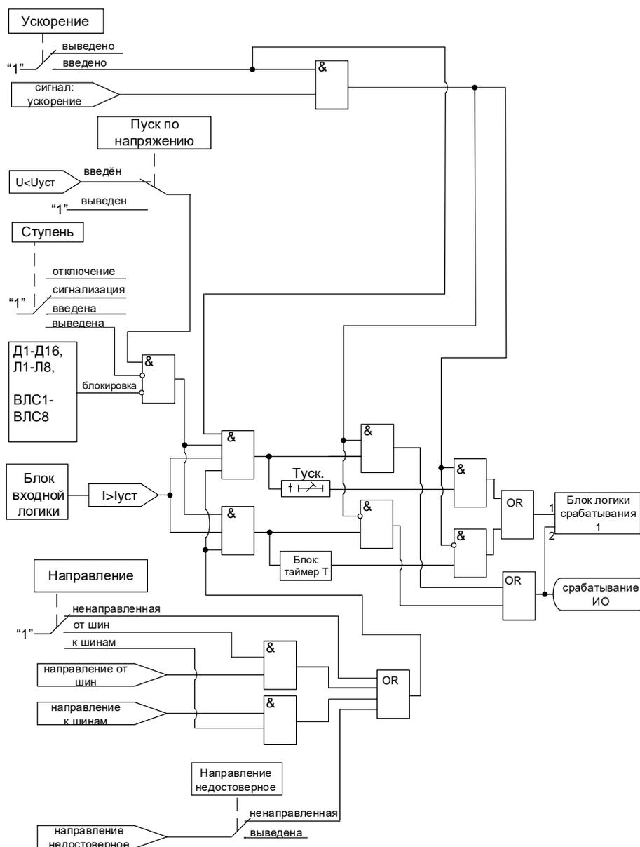
Рисунок 6.4а – Логическая схема направленной защиты от повышения тока для ступеней I>, I>> MP5 ПО73
