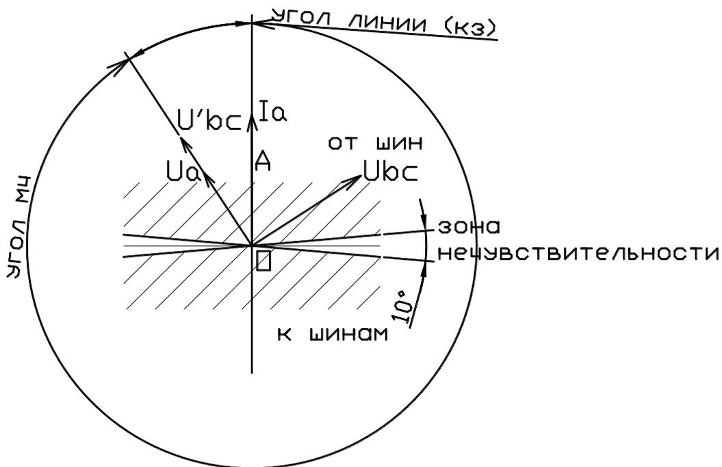
Рисунок 10.4 – К определению угла максимальной чувствительности.
