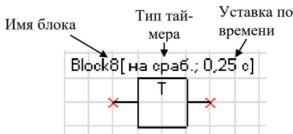
Рисунок 6.43– Таймер
