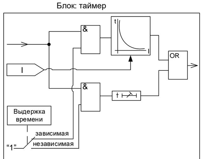
Блок-схема логики срабатывания 1
