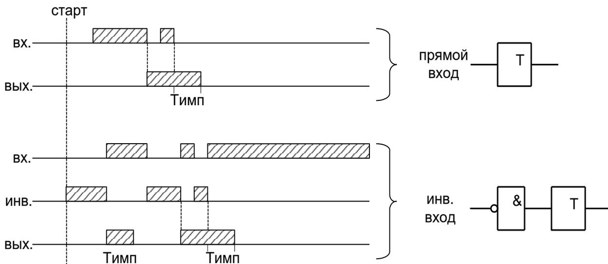
Рисунок 6.49 – Импульсный таймер по спаду типа 2 (таймер 6)
