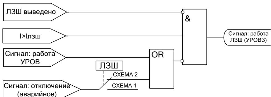
Рисунок 6.19а – Блок-схема логики УРОВЗ
