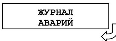
На дисплее отобразится заголовок аварии с датой, временем и номером аварии (отсчет ведется от последней аварии).
