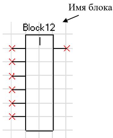
Рисунок 6.39 – Логический элемент «ИЛИ»
