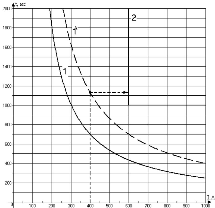
Рисунок 10.10 – Пример согласования обратозависимой характеристики устройства МР и независимой характеристики МТЗ последующего элемента
