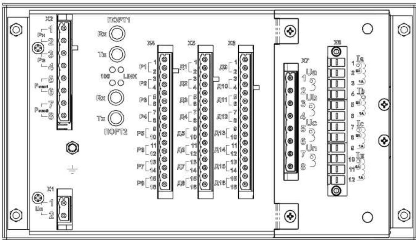
Рисунок Б.3 – Вид задней панели терминала защиты энергооборудования MP5. **Вариант 3**
