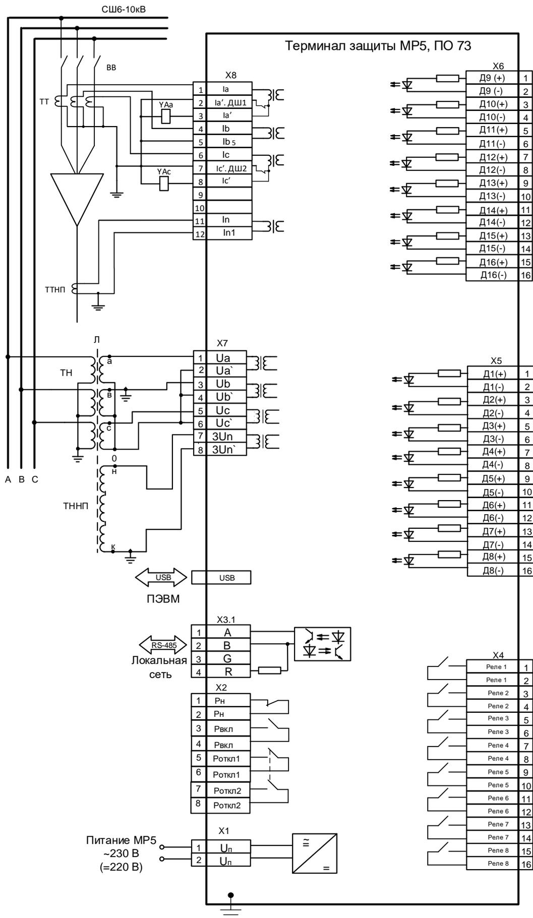
Рисунок В.7 – Схема подключения с 3-мя трансформаторами тока, исполнение с функцией дешунтирования. **Вариант исполнения 1**
