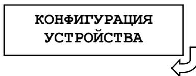
Информация в данном меню всегда доступна для просмотра. В случае внесения каких-либо изменений при выходе из меню «КОНФИГУРАЦИЯ УСТРОЙСТВА» будет запрошен пароль. При вводе правильного пароля изменения вступят в силу.
