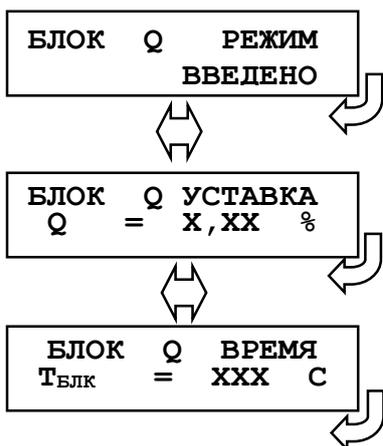
Ввод уставки блокировки пусков двигателя по тепловому состоянию. Диапазон значений: 0-256 %.
