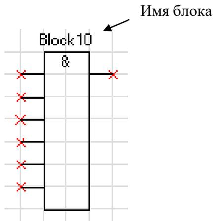
Рисунок 6.38 – Логический элемент «И»
