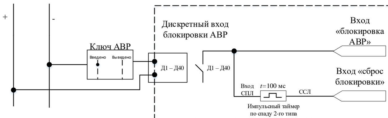
Рисунок 10.12 – Схема для оперативного ввода/вывода АВР из работы
