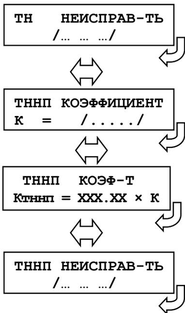
Конфигурирование внешнего сигнала неисправности фазного трансформатора напряжения. Список сигналов в Приложении Г, таблица Г.2.
