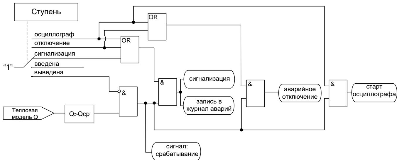
Рисунок 6.31 - Логическая схема ступени защиты от перегрева
