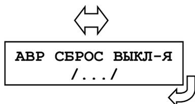
Сброс блокировки АВР, возврат схемы АВР в начальный шаг по включению/отключению выключателя. Значение параметра: «ЗАПРЕЩЕНО», «РАЗРЕШЕНО».
