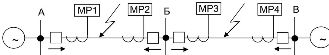
Рисунок 6.3 – К выбору зависимой характеристики смежных участков
