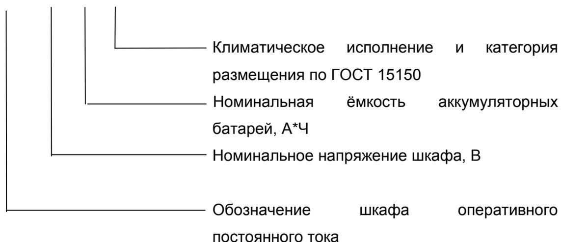
Пример записи шкафа на номинальное напряжение 220 в, ёмкость аккумуляторных батарей 72 А\*Ч, климатическое исполнение «У», категорию размещения «З» при заказе:
