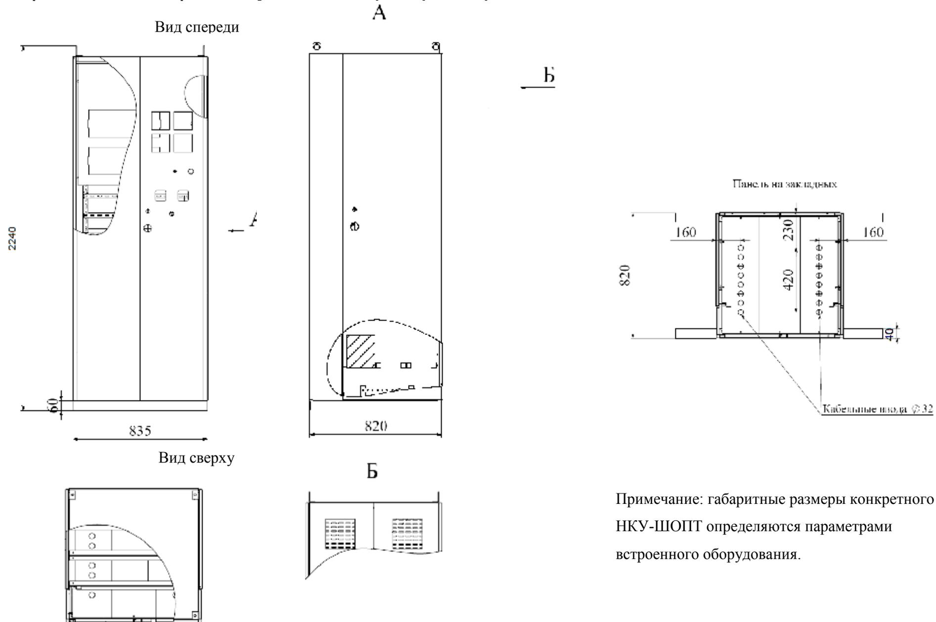
Примечание: габаритные размеры конкретного НКУ-ШОПТ определяются параметрами встроенного оборудования.
