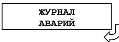
На дисплее отобразится заголовок аварии с датой, временем и номером аварии (отсчет ведется от последней аварии).
