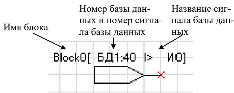
Рисунок 6.22 – Разъём «Вход»
